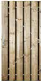
HAMBURG DEUR MET STALEN FRAME - GESCHAAFD Naaldhout, Celfix® verduurzaamd, RVS geschroefd. Inclusief cilinderslot, klink, duimen en verstelbare ogen. Links- en rechtsdraaiend. Planken: 1,6x14,5 cm 90x180 cm - 1003031
