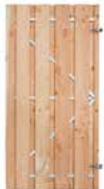
BRECHT DEUR MET STALEN FRAME - GESCHAAFD Lariks/douglas onbehandeld, RVS geschroefd. Inclusief cilinderslot, klink, duimen en verstelbare ogen. Links- en rechtsdraaiend. Planken: 1,6x14,5 cm 90x180 cm - 1003874
